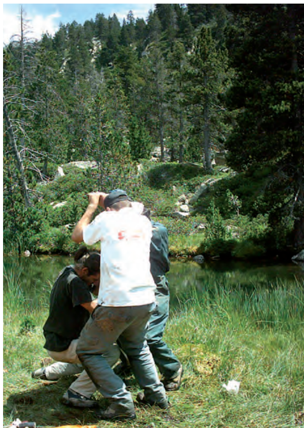
Figura 3. Sondeo con sonda manual del tipo ruso de la turbera de Bosc dels Estanyons (Foto: Y. Miras)
