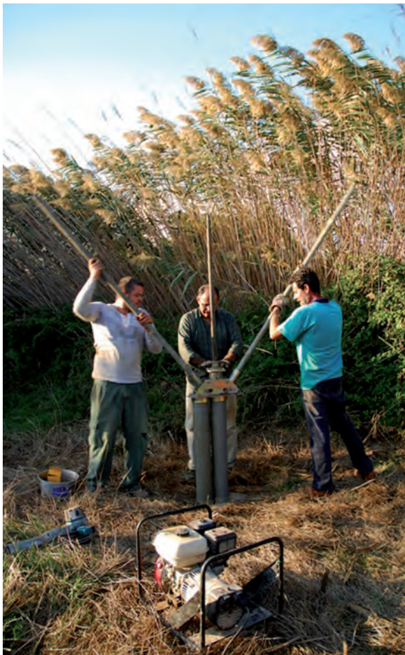
Figura 3. Trabajos con equipo portátil durante una de las campañas de sondeo en las Islas Baleares (Foto: M. Mari)
